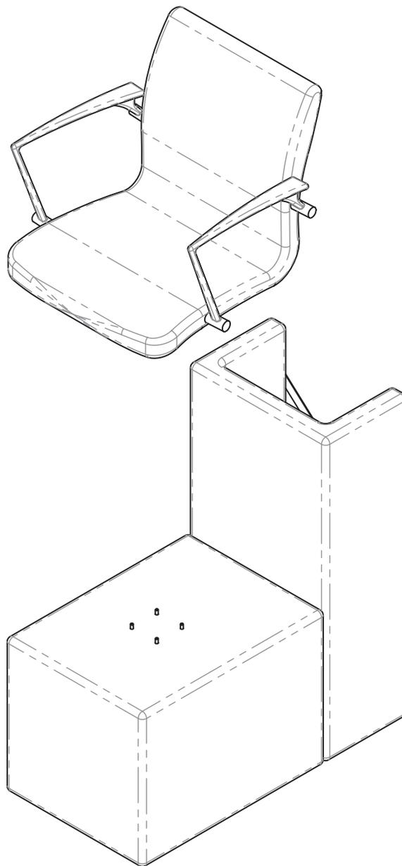
1. Déposer la chaise sur la base en alignant les trous de boulon / Place the chair on the base, alignin the bolt holes
