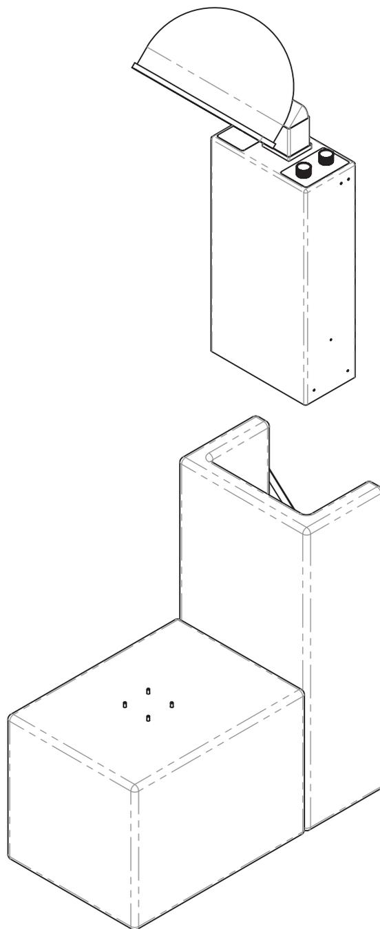
3. Glisser le casque séchoir dans l'emboîtement arrière de la base / Slide the hooded dryer into the rear slot of the base
