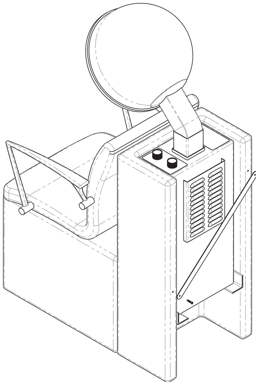
4. Visser le support transversal **F** de sécurité à l'aide des vis **E** à l'arrière de la base pour empêcher le casque séchoir de basculer / Screw the safety cross bracket **F** using the screws **E** at the back of the base to prevent the hooded dryer from falling.
