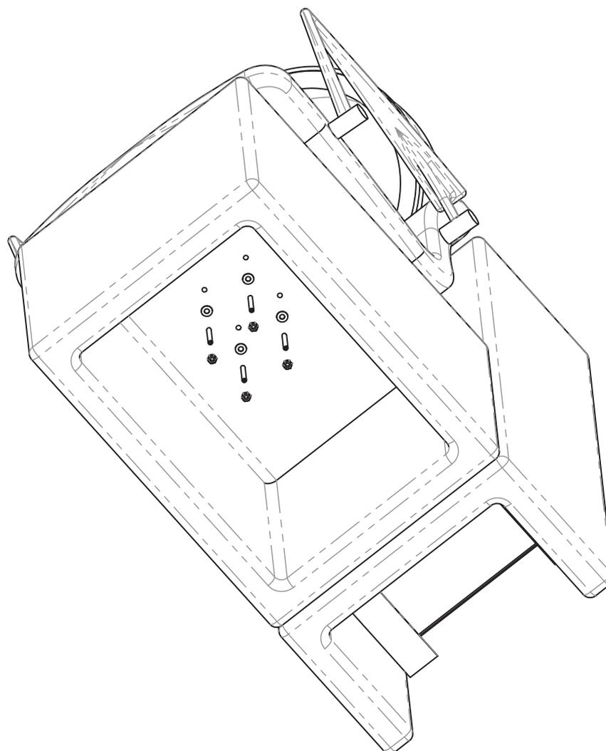
2. Visser les boulons **(A)** et sécuriser avec les rondelles **(C)** et les écrous **(D)**. \*Utiliser les boulons **(B)** pour le modèle de chaise Lea\* / Screw in the bolts **(A)** and secure with the washers **(C)** and nuts **(D)**. \*Use the bolt **(B)** for the Lea chair model\*
